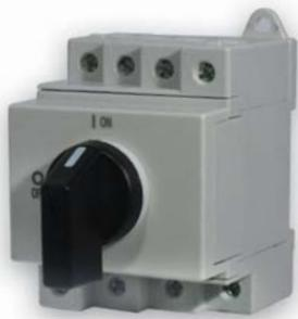
**Применение** - Выключатели LS SMA применяются для коммутации преобразователей тока DC/AC, а также других элементов фотоэлектрических систем PV. Конструкция выключателей позволяет коммутировать нагрузки до 32А при напряжении 1000V DC (категория DC 21B). Контакты выключателя изготовлены из материала, который минимизирует их окисляемость при длительном использовании. Минимальное время коммутации защищает устройство от нагрева.
