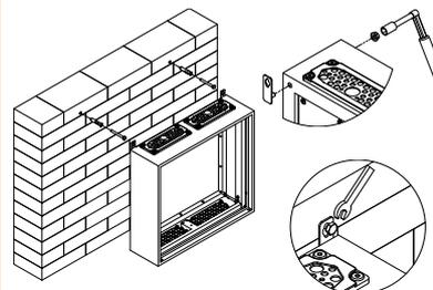
Такой способ монтажа позволяет устанавливать собранный щит вместе с оборудованием в закрытом состоянии.
