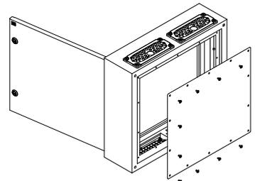
Задняя стенка выполнена из оцинкованного стального листа, монтируемого при помощи саморезов. Съемная задняя панель обеспечивает удобный доступ к установленному оборудованию во внутренней части щита.
