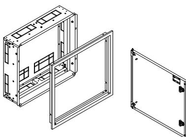
Щит внутренней установки состоит из кассеты и съемной рамки со сплошной дверцей.
