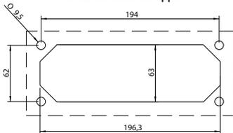
Щиты наружной установки имеют отверстия для подвода кабеля (стандарт FL21). Также в щите сверху стандартно установлены мембранные фланцы EN-TK-36, а в нижней части установлены пластиковые заглушки. В случае нижнего подвода кабелей существует возможность поворота щита на 180 градусов. В аксессуарах можно отдельно заказать мембранные, стальные и алюминиевые фланцы.
