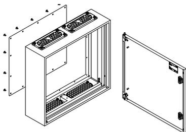
Щит наружной установки состоит из корпуса со съемной задней крышкой и сплошной дверцей.
