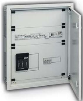
**Применение** - Металлические щиты серии GSX имеют широкое применение для решения задач распределения электроэнергии в жилых и общественных зданиях при установке большого количества устройств защиты и управления. При глубине 160 мм в щиты GSX можно установить до 252 модульных устройств. Также возможны комбинации с автоматическими выключателями EB2 125, 160, 250А, выключателями нагрузки LA1, LA2 и разъединителями предохранителей HVL00.
