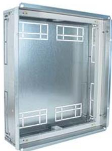
Изготовлена из листовой оцинкованной стали толщиной 1 мм. Имеет перфорацию отверстий для прокладки кабелей и проводов. Также имеет перфорацию для монтажа в нише. Болты M6x40, которые поставляются в комплекте, служат только для позиционирования кассеты. Окончательный монтаж производится с помощью распорных дюбелей (в кассете отверстия диаметром 9 мм и 6 мм) и монтажной пены (в кассете имеются отверстия для заполнения монтажной пеной).
