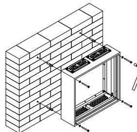
Такой тип установки не позволяет проводить демонтаж без открытия двери.
