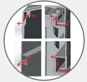
→ Конструктивно предусмотренная природная вентиляция шкафа минимизирует скопление влаги внутри
