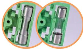
→ Клеммы серии ESC-SFR для подключения проводников сечением от 0,2 до 10 мм<sup>2</sup> применяются для защиты цепей управления с помощью устанавливаемой в держатель плавкой вставки. ESC-SFR.4 - для предохранителей 5x20, коммутирующего цилиндра из латуни 5x20 или диода 5x20. ESC-SFR.6 - для предохранителей 6x32
