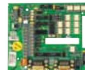
Дополнительно встраиваемые платы программируемого логического контроллера PLC1 и PLC2
