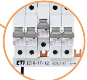
→ Все автоматические выключатели имеют возможность одновременного подключения шины питания и проводника как сверху, так и снизу
