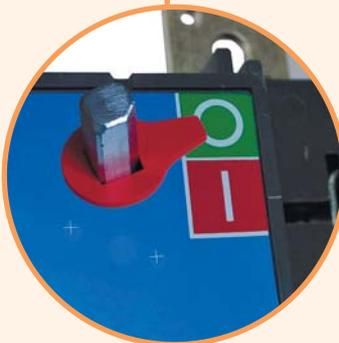
→ Индикатор положения силовых контактов выключателя
